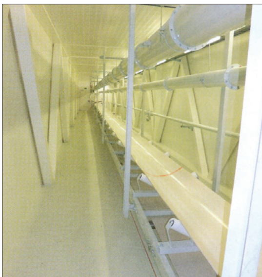
شکل ۳: باند انتقال شکر قاشقی شکل بدون پوشش
