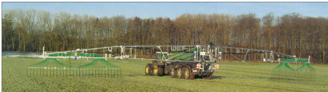
پخش ضایعات تخمیری تولید بیوگاز به کمک پخش کننده شلنگی با بازوهای به طول ۳۶ متر
